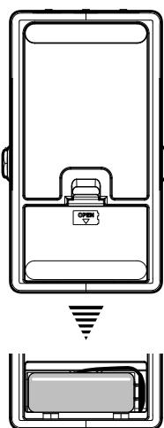
Quand la pile est presque plate, l'écran affiche "LOW BATT". Remplacez rapidement la pile par une neuve. Quand la pile est complètement plate, l'écran s'éteint et la pédale ne produit plus de son.
