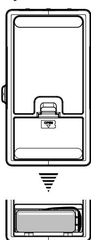
Lässt die Batterieleistung nach, erscheint im Display „LOW BATT.“ Wechseln Sie die Batterie so schnell wie möglich aus. Ist die Batterie komplett entladen, erlischt das Display und am Ausgang liegt kein Signal mehr an.
