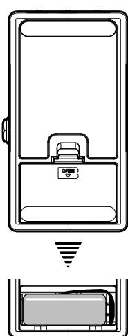
Cuando la pila empiece a agotarse, la pantalla indicará "LOW BATT". Instale una pila nueva tan pronto como sea posible. Cuando la pila se agote del todo, la pantalla se apagará y dejará de salir sonido.
